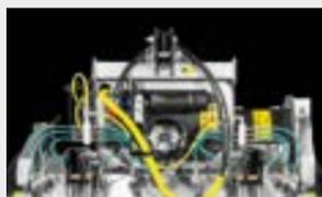
Система впрыскивания воды WSS Basic для снижения пылеобразования и охлаждения зубьев
